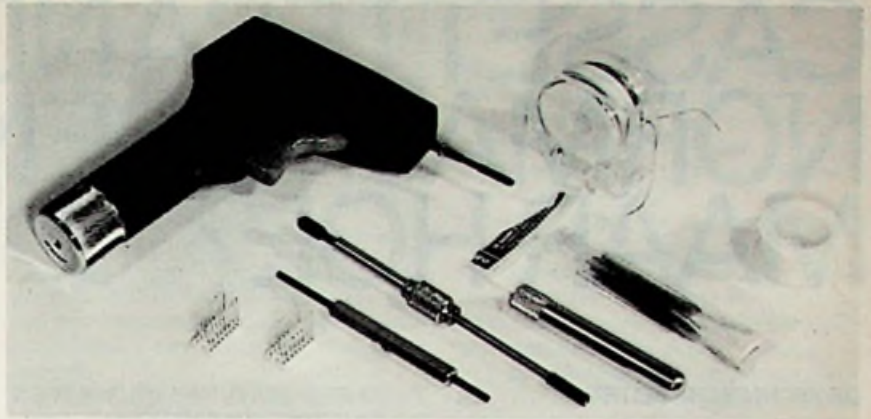
afb. 7 Enige wire wrap artikeltjes zijn afgebeeld: een handgereedschap met wrap, ontwrap en strip mechaniek, wire wrap draad zowel op een spoeltje als het te verkrijgen voorgestripte wire wrapdraad op lengte. Als laatste is een batterij gevoed pistool te zien. afb. 8 Enige verkrijgbare wire wrap IC-voeten van Modelec, daarnaast liggen de verkrijgbare wire wrappennetjes, ook zijn deze in allerlei uitvoeringen te krijgen, n.l.
